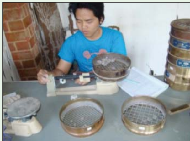
รูปที่ 3-12 แสดงการหาขนาดละเอียดของมวลรวม
