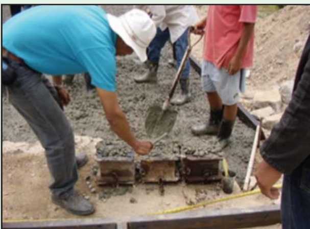
รูปที่ 6-55 การเก็บตัวอย่างคอนกรีตเพื่อทดสอบ
