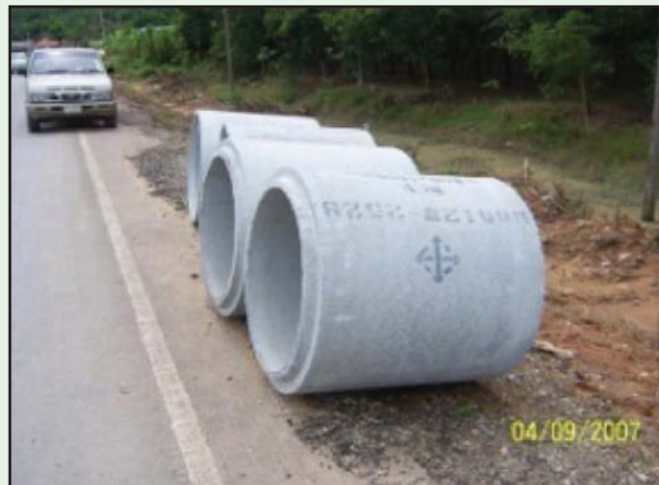
รูปที่ 5-3 ลักษณะท่อที่ดี ผิวเรียบ ไม่พรุน ปากไม่บิ่น ไม่มีรอยแตกร้าว
