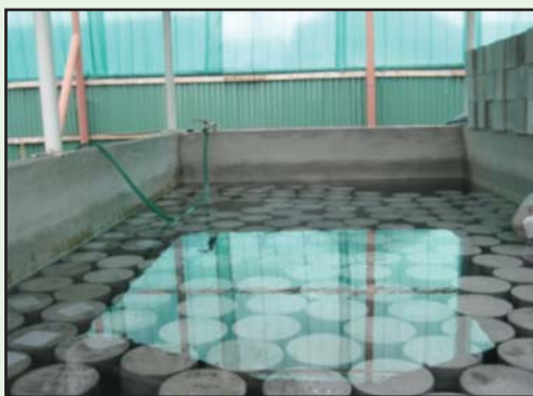
รูปที่ 3-19 การบ่มก้อนตัวอย่าง และการทดสอบหาค่ากำลังอัดประลัยก้อนตัวอย่างคอนกรีต
