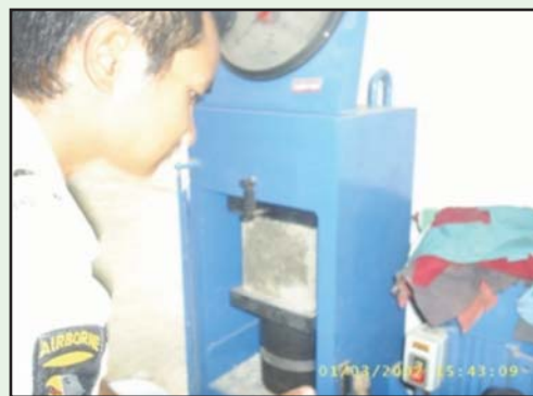
รูปที่ 3-19 การบ่มก้อนตัวอย่าง และการทดสอบหาค่ากำลังอัดประลัยก้อนตัวอย่างคอนกรีต
