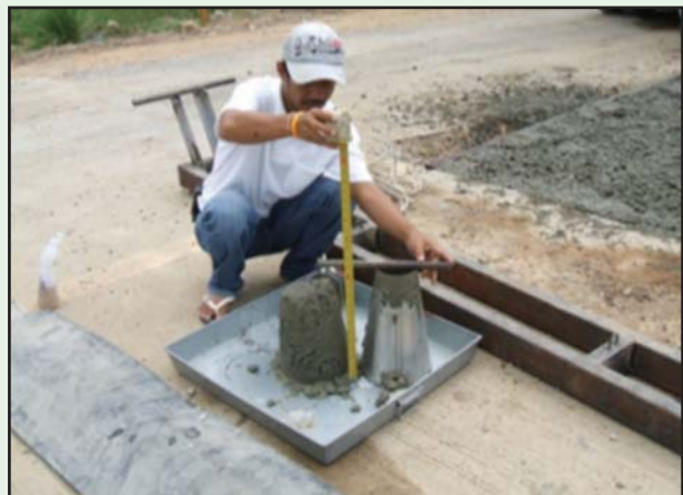
รูปที่ 6-56 ตรวจสอบความชันเหลวทันทีที่รถลำเลียงมาถึง
