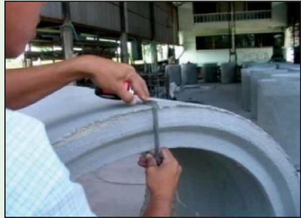
รูปที่ 5-2 การตรวจสอบคุณสมบัติของท่อทั้งในระหว่างการผลิตและการนำส่ง
